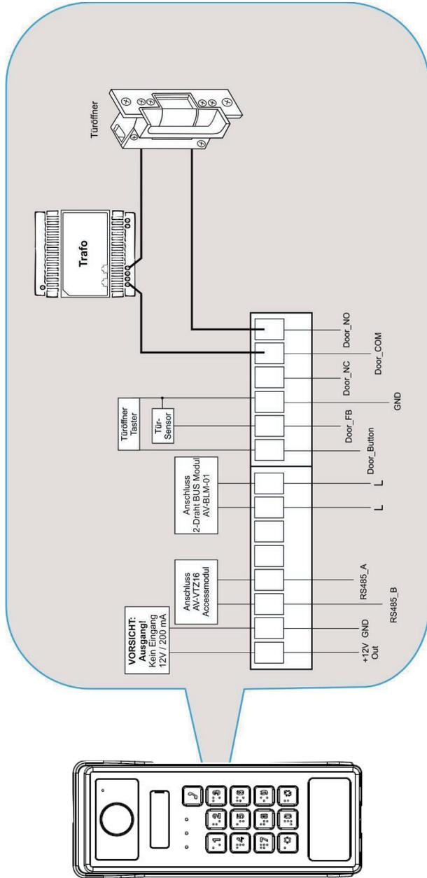
**Wichtiger Hinweis:** Beim Anschluss eines Türöffners ist unbedingt ein separater Trafo zu verwenden, der speziell für das Türschloss geeignet ist.
